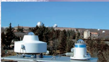
Au premier plan les deux pyranomètres mesurant en continu la lumière solaire, dans son spectre total et en ultraviolet, pour l'étude de l'atmosphère terrestre.
