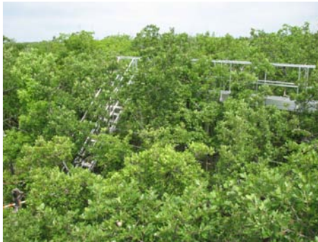
Les Passerelles de l'O3HP, en forme de croix, délimitent 4 zones d'études. Elles comportent 2 étages et s'élèvent à 4m de hauteur.
